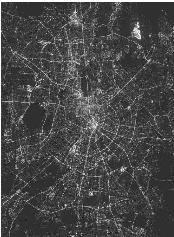
Abb. 12: Fotomosaik der Stadt Berlin aus einer Flächenbefliegung mit einem Flugzeug aus rund 3 km Höhe.
