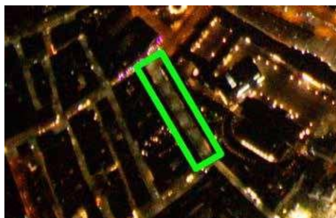
Abb. 28: Messfeld Breite Gasse in 1070 Wien. Rechts daneben ist das Museumsquartier mit zahlreichen, nach oben strahlenden Gebäudestrahlern gut sichtbar.
